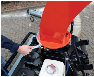
Der Auslassstutzen kann um 360 Grad gedreht werden.
