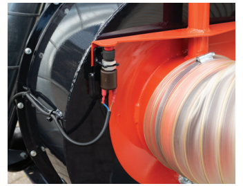
Ein Sicherheitssensor am Lüftergehäuse schaltet den Motor während Wartungsarbeiten ab.
