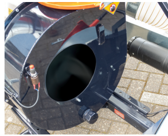
Leichter Zugang für Reinigung des Laufrads.
