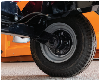
Straßensicher für 80 km/h Verzinkte Drehmomentwellenaufhängung.
