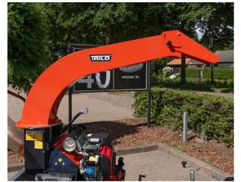
Von TRILO entwickelt: praktischer quadratischer Schacht für hervorragenden Luftstrom.
