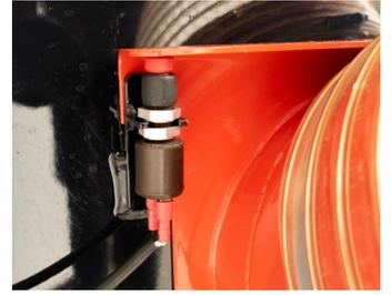
Ein Sicherheitssensor am Lüftergehäuse schaltet den Motor während Wartungsarbeiten ab.
