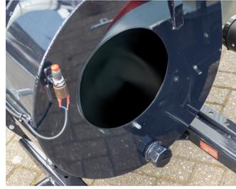
Einfacher Zugriff auf das Laufrad und die Verschleißplatten für Wartungsarbeiten.
