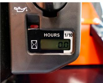
Ausgestattet mit Hondas Warnsystem für niedrigen Ölstand und einem Stundenzähler.
