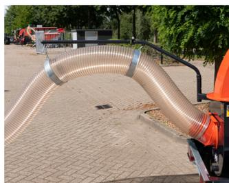
Der Saugschlauch mit einem Radius von 5 m wird von einem schwenkbaren Ausleger getragen.
