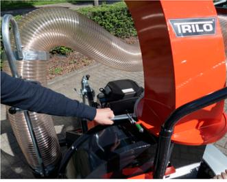
Der Auslassstutzen kann um 360 Grad gedreht werden.
